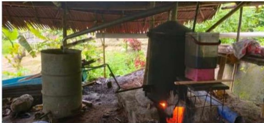
Gambar 2. Alat Penyuling Minyak Cengkeh di IKM Bintang Binaya
